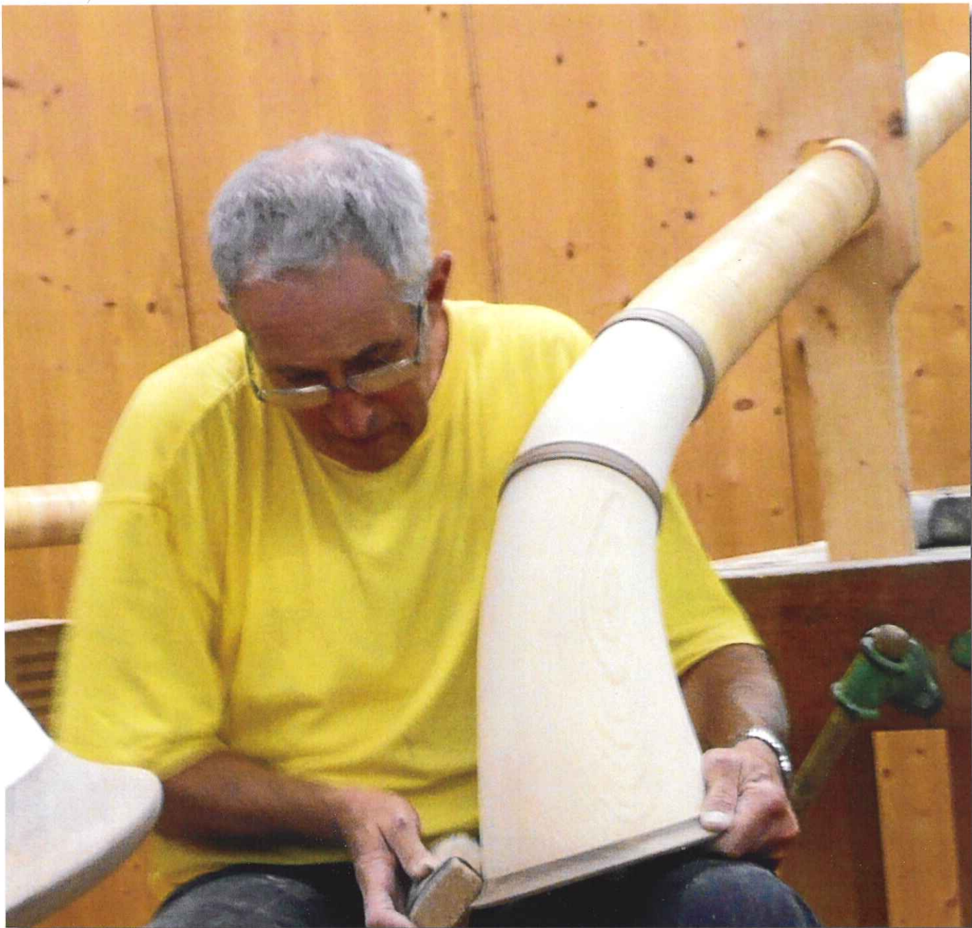
Die Verbindung zwischen Becher und Becherring muss genau übereinstimmen
