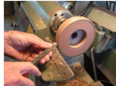
Abb. 24: Abrunden und Verziern des Rings auf Drehbank
