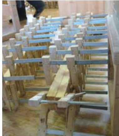
Abb. 4: Frisch geleimte Rohre
