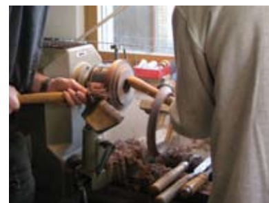
Abb. 28: Der abgestochene Becherring wird aufgefangen
