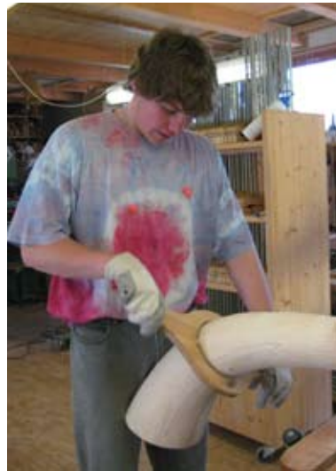
Abb. 9: Ring zum markieren der Becherform
