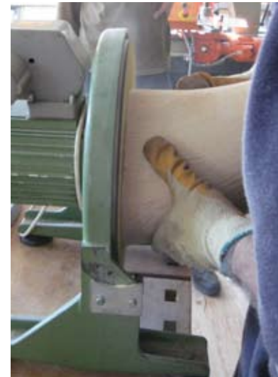
Abb. 10: Becher wird an Stirnseite egalisiert
