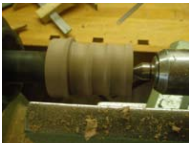
Abb. 21: Fässchen in Drehbank eingespannt
