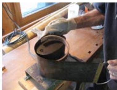
Abb. 22: Biegen eines Rings um heisses Eisen
