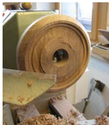
Abb. 27: Becherring an Drehbank
