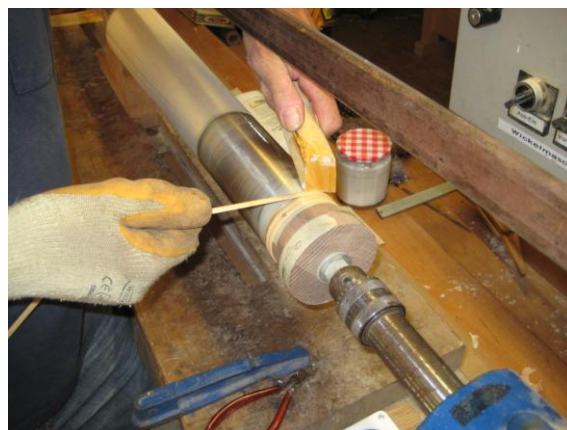
27 - Aufleimen des Peddigrohrs auf die Metallkappe, 10.06.2009
