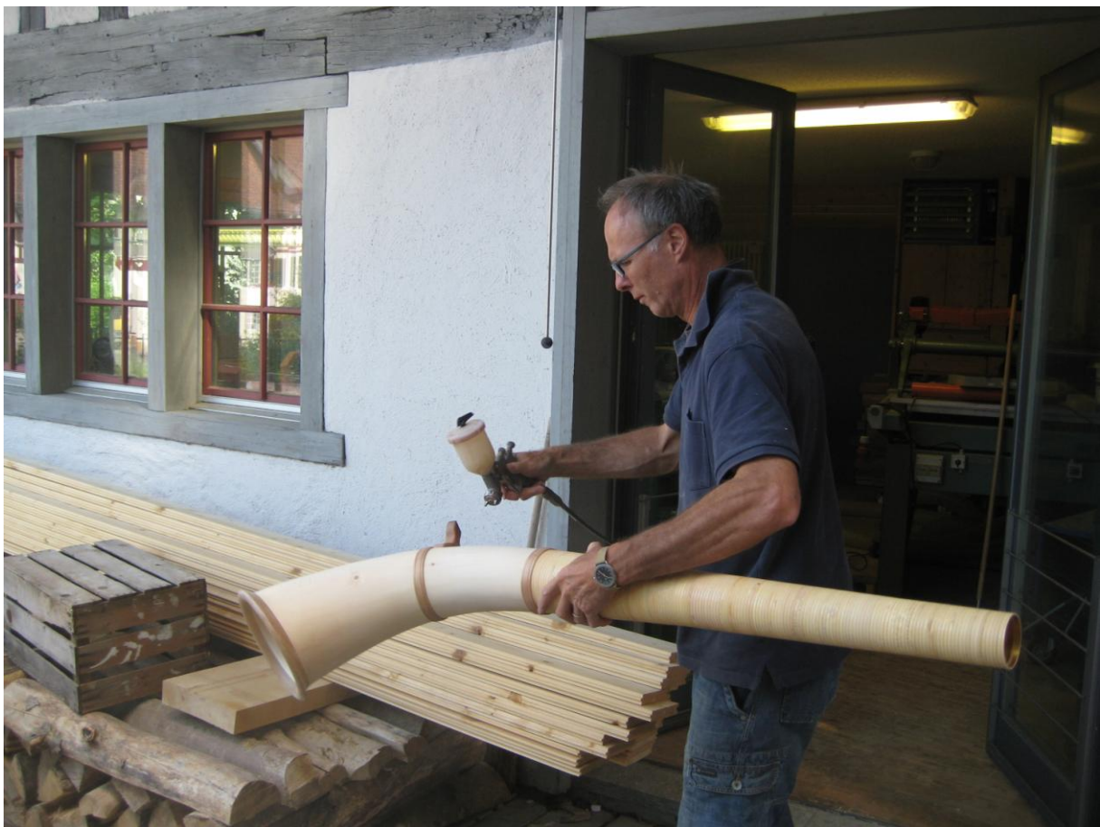
32 - Grundieren und Lackieren des Bechers, 13.06.2009
