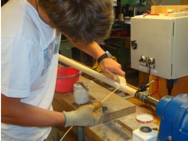
28 - Verleimen des Peddigrohrs (Teil 1), 9.06.2009
