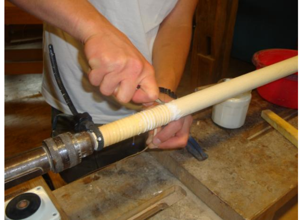
29 - Verleimen des Peddigrohrs (Teil 2), 9.06.2009
