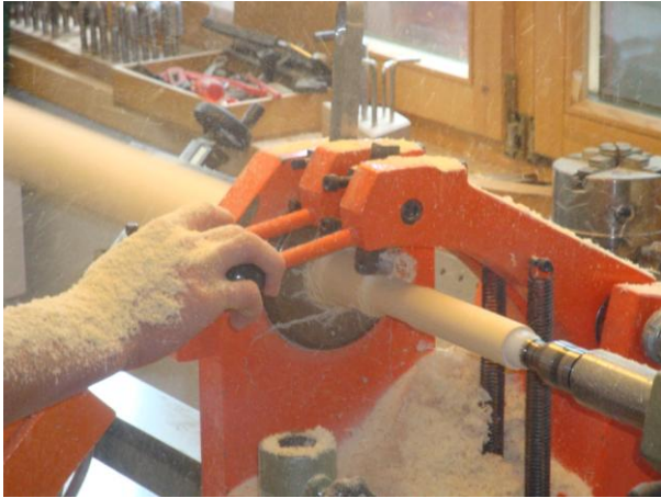
17 - Drechseln des Handrohrs, 9.06.2009
