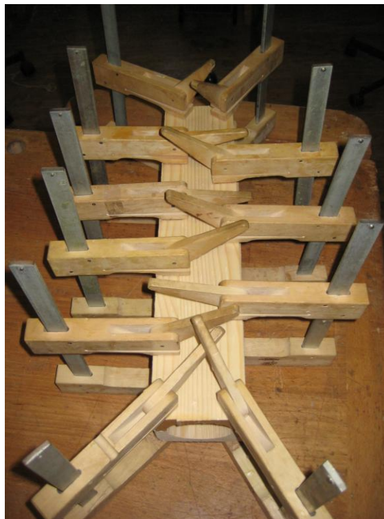
16 - Verleimen des Bechers, mit Hilfe von elf Klemmen, 8.06.2009
