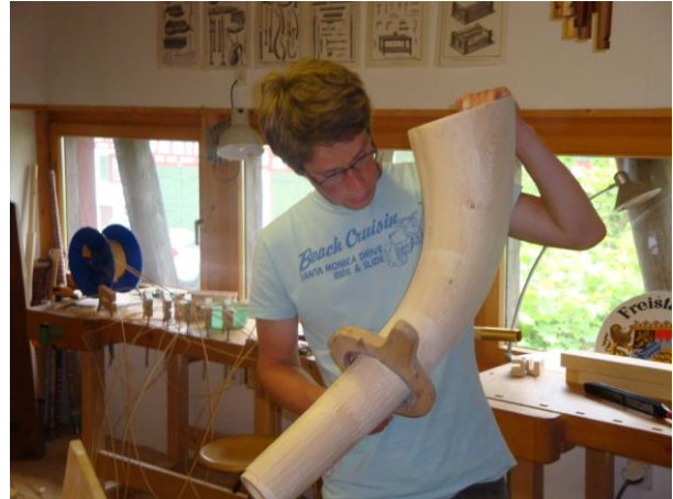
13 - Einschleifen der Markierungen in den Becher, 8.06.2009
