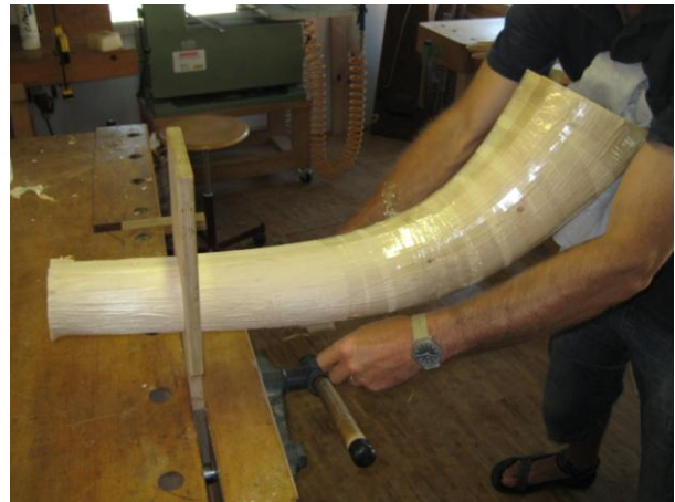
11 - Verleimen der Becherhälften, 8.06.2009
