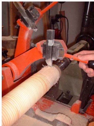
Andrechseln des Mittelrohrs für die Aussenbüchse
