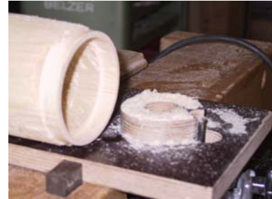
Der Becher wird innen angeschnitzt, damit man ihn mit dem Becherrohr zusammenstecken kann
