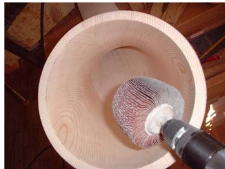
Der Becher wird innen geschliffen
