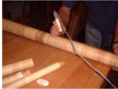
Markierungen werden mit dem Brennstab eingebrannt
