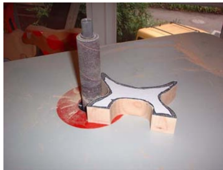
Das Füßchen wird geschliffen
