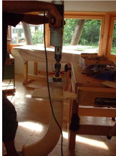
Becher wird ausgebohrt
