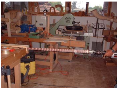
Konischer Bohrer zum Schleifen der Rohre
