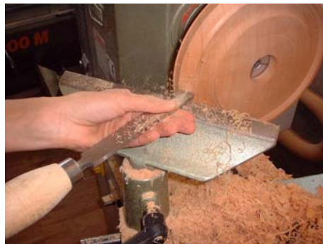
Drechselarbeit am Becherring
